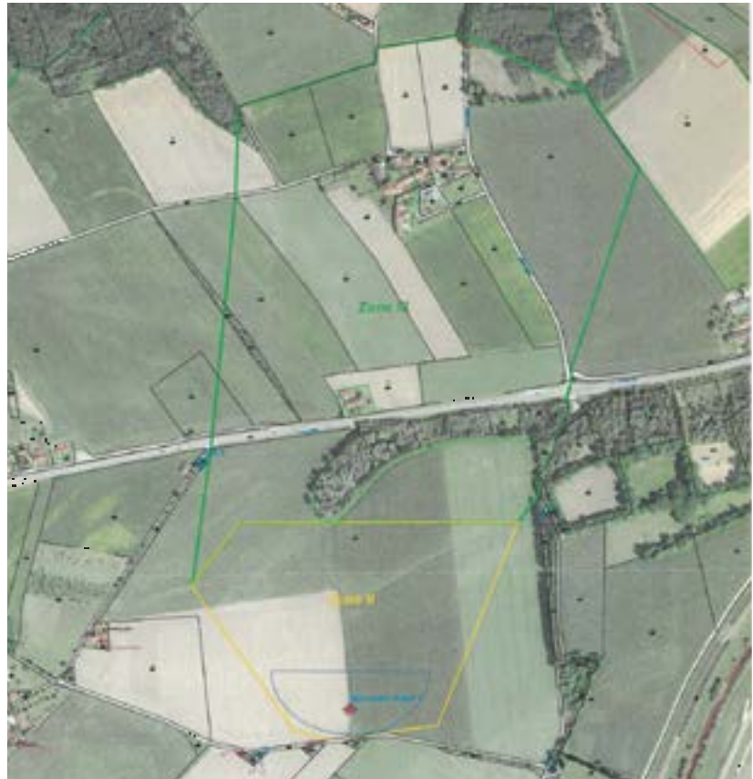
Darstellung der Schutzzonen 1, 2 und 3 der zukünftigen Trinkwasserversorgungsanlage für die wasserrechtliche Genehmigung mit der Bezeichnung Brunnen Haid 1. © mjp Zivitechniker GmbH
